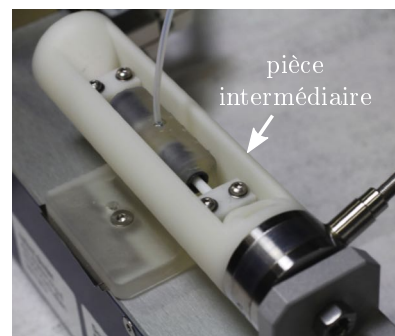
FIGURE 4.35: Banc de test pour l'évaluation avec piston mobile (réalisé à l'université de Mannheim). a) Schéma ; b) vue CAO en coupe ; c) Photographie
