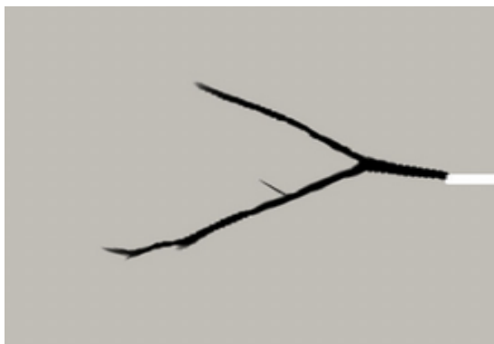
(c) Branchement de fissure dans du mortier [25]
