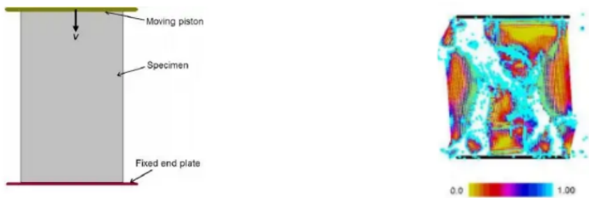
Figure 1.26 – Simulation d'une compression uniaxiale avec la méthode SPH [37]
