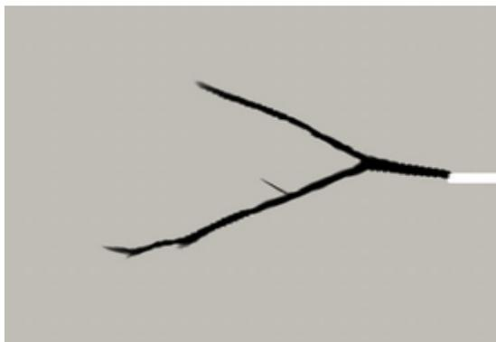
(c) Branchement de fissure dans du mortier [25]
