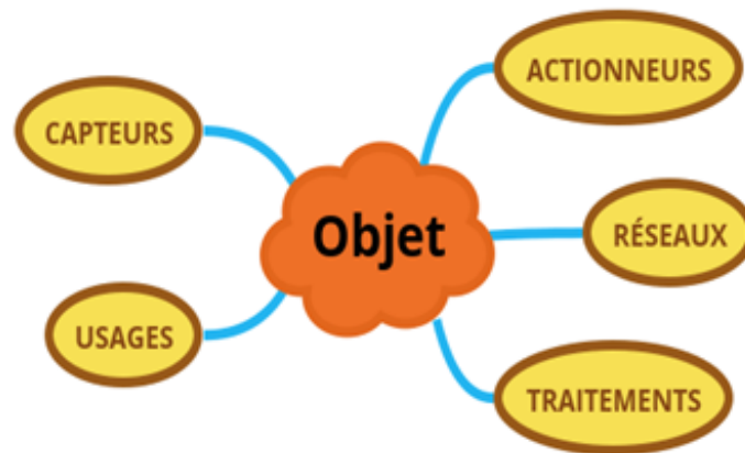
FIGURE 2.2 – Éléments constitutifs d'un objet connecté – Source : [2]
