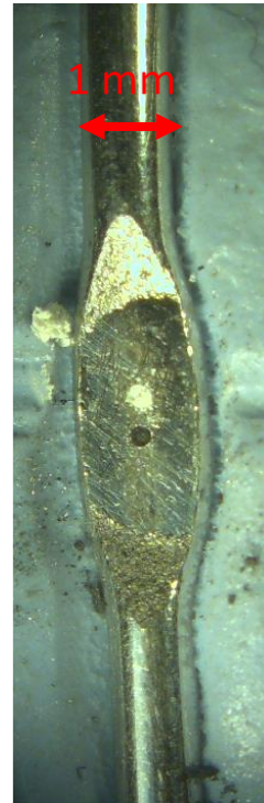
Figure 59 : a) photo du four sous l'objectif du microscope Raman et b) photo du fil de platine iridié centré sur le méplat servant d'élément chauffant et de porte-échantillon.
