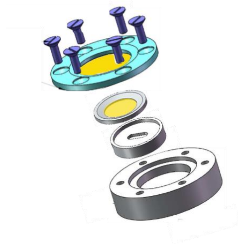
Figure 70 : porte-échantillon assigné aux analyses en mode fluorescence basses énergies en acier inoxydable. Les deux fenêtres laissant passer le faisceau sont en Kapton (jaune).
