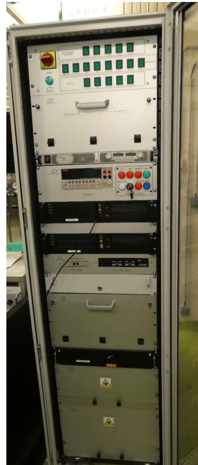
Figure 50 : photos du microscope Raman installé en boîte à gants (a) et relié au spectromètre dans la baie électrique (b) par fibres optiques.
