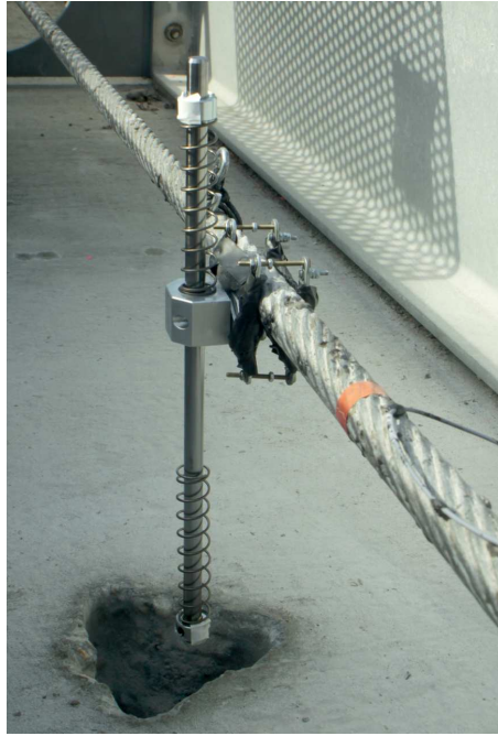
FIGURE 5.25 – Photo du prototype de NES linéaire par morceaux mis en place sur le câble sur le banc de traction pour un essai. Les déplacements et les accélérations du NES et du centre du câble sont mesurés par deux capteurs de déplacements laser et deux accéléromètres, respectivement. La problématique du débattement vertical du NES est soulignée dans cette partie par la nécessité de créer un trou dans le sol.
