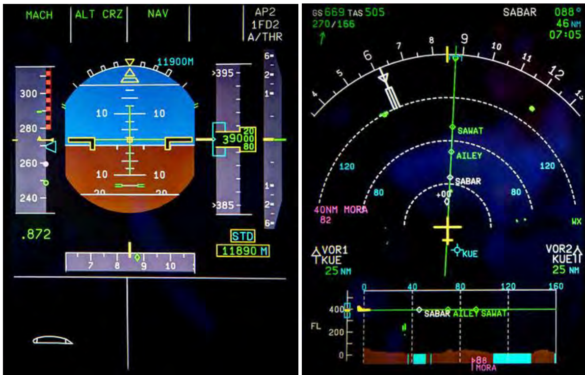
Figure 23 - Instruments nécessaires à la conduite de l'avion, PFD à gauche et ND à droite. Tirée de : https://i0.wp.com/blogrh-thomasvilcot.com/wp-content/uploads/2017/06/Plan-de-vol.jpg?ssl=1
