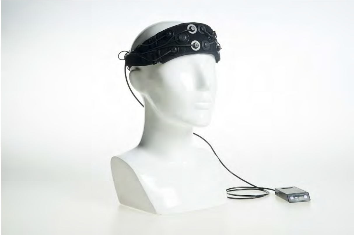
Figure 17 - Exemple de système fNIRS (ici de type Artinis Octamon, système utilisé dans notre étude), ici sous forme de bandeau frontal afin de mesurer les variations d'oxygénation au niveau du cortex préfrontal.
