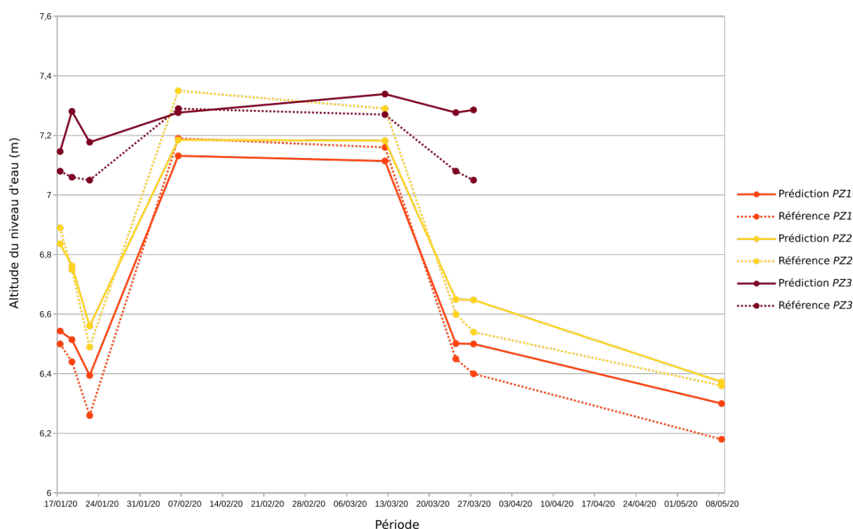
FIGURE 4.11 – Prédiction de l'altitude du plan d'eau pour chaque compartiments (HGMU) contenant une sonde piézométrique sur Sougéal lors de la période de validation (2020). Lors des périodes les plus sèches l'altitude du plan d'eau du compartiment PZ3 est sous la surface du sol et donc invisible pour les données satellitaires.
