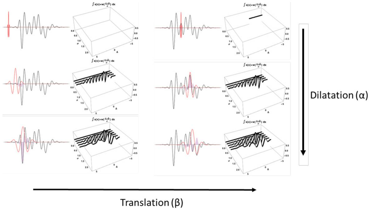
Figure 15 : Exemple de translation et dilatation lors d'une transformée en ondelettes continue. L'intégrale de la zone grise, correspondant à la convolution de l'ondelette fille (rouge) et du signal (noir), est reportée sur la carte de droite, à la fréquence donnée par  $\alpha$  et au temps donnée par  $\beta$ .
