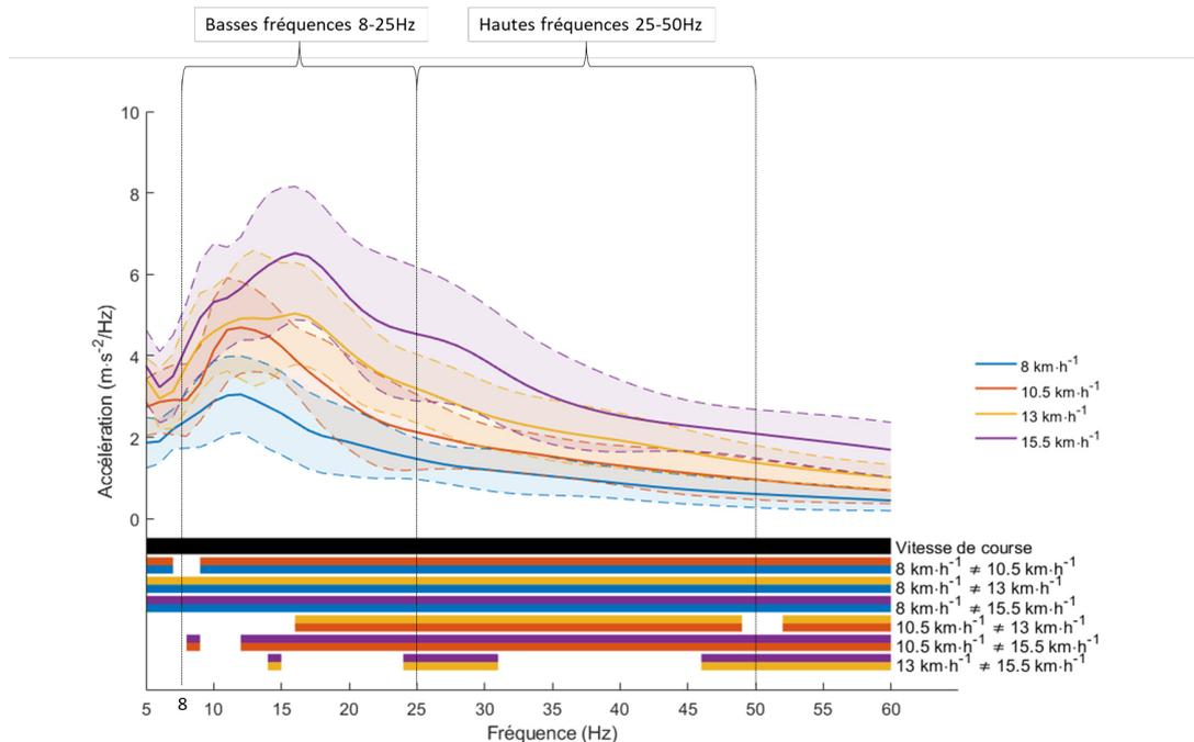
Figure 26 : Effet de la vitesse de course sur la représentation fréquentielle de la vibration du gastrocnemius medialis. En dessous des courbes, l'ANOVA (bande noire) et les tests post-hoc (bandes bicolores) sont représentés. Une couleur est au-dessus d'une autre, cette condition entraîne plus d'énergie à ces fréquences que l'autre. Adapté de Trama et al. (2019a).
