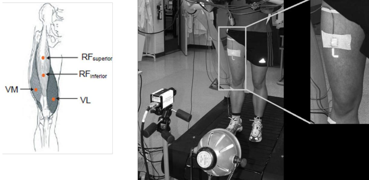
Figure 9 : Matériel utilisé pour mesurer conjointement la vibration à l'aide d'un accéléromètre et de vidéo à haute fréquence. Gauche : Position des marqueurs sphériques utilisés par Borràs et al. (2011) et droite : Marqueur en forme de « L » utilisé par Coza et al. (2010).
