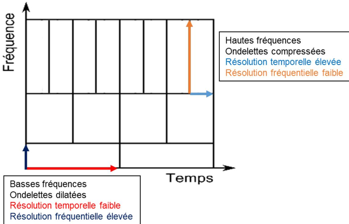
Figure 16 : Pavage temps-fréquence de l'analyse en ondelette. Les basses fréquences sont bien définies dans le domaine fréquentiel et moins bien dans le domaine temporel alors que l'inverse est rencontré pour les hautes fréquences.
