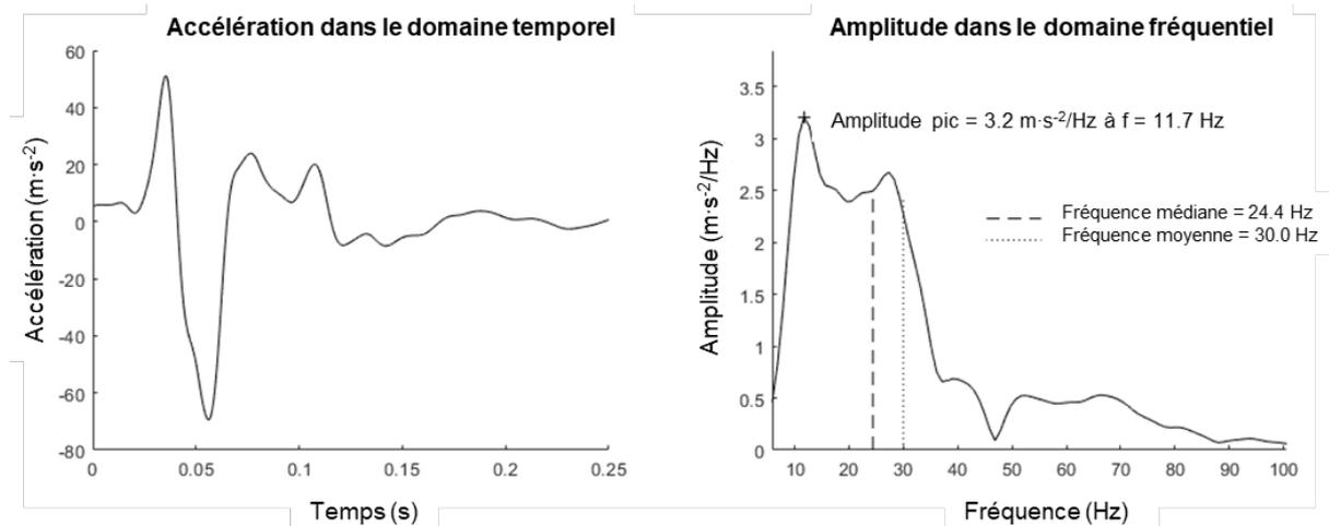
Figure 13 : Signal dans le domaine temporel et son spectre fréquentiel obtenu après une transformée de Fourier rapide.
