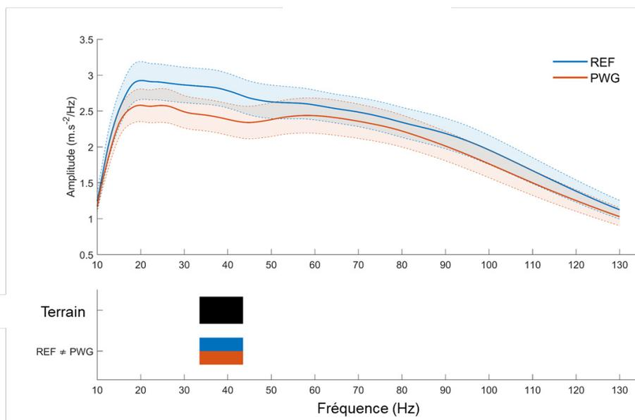
Figure 34 : Effet du type de terrain sur la représentation fréquentielle de l'impact au sol après une analyse SnPM sur les données présentées dans l'article. En dessous des courbes, L'ANOVA (bande noire) et la bande bicolore montrent un effet du terrain, avec moins d'amplitude pour le sol PWG comparé au sol REF, de 34 à 44 Hz. Adapté de Trama et al. (Accepté).
