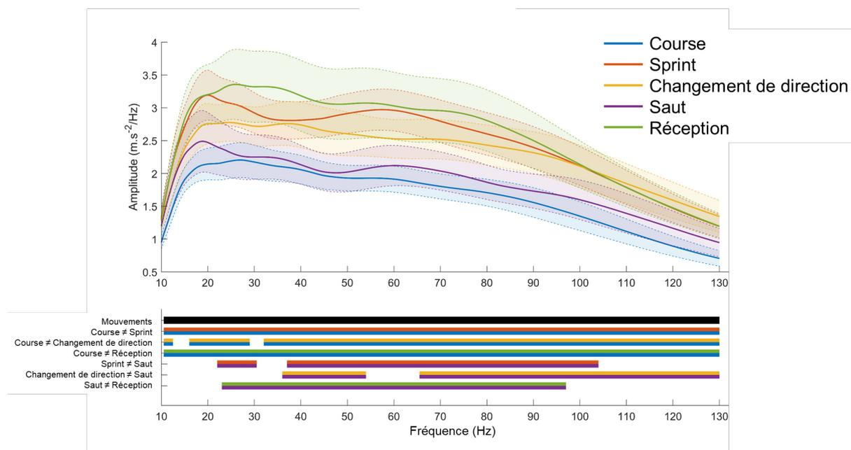
Figure 27 : Effet du type de mouvement sur la représentation fréquentielle de l'impact au sol après une analyse SnPM. En dessous des courbes, L'ANOVA (bande noire) montre un effet du mouvement de 10 à 130 Hz. Les différences significatives entre deux vitesses sont représentées par les bandes bicolores. Si une couleur est au-dessus d'une autre, cette condition entraîne plus d'énergie à ces fréquences que l'autre. Adapté de Trama et al. (accepté).
