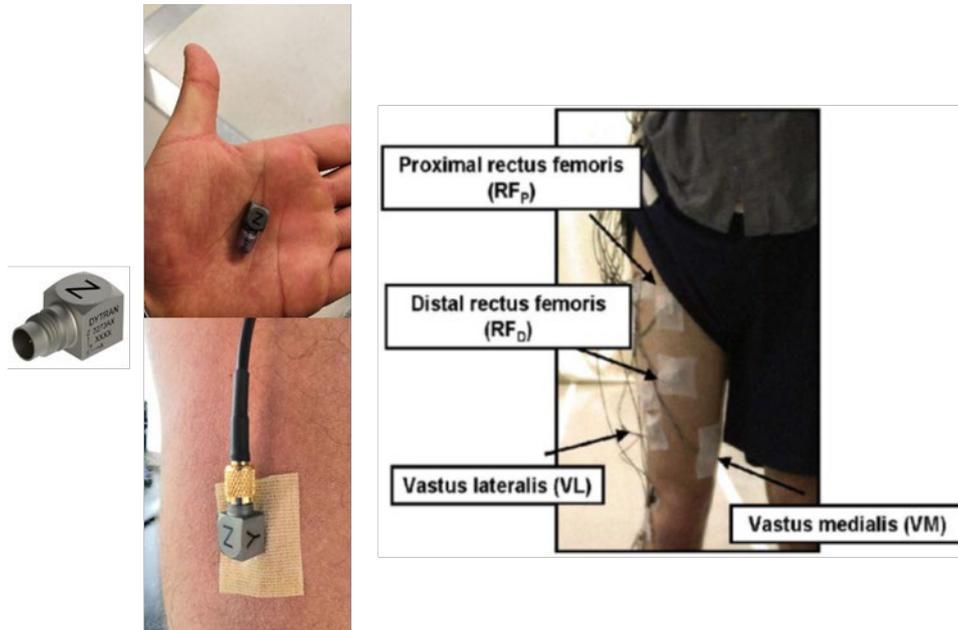
Figure 8 : Exemple d'un accéléromètre tri-axial léger ( $\approx 2.7$  grammes) et compact ( $\approx 1.08$  cm<sup>3</sup>) à gauche et positionnement de différents accéléromètres sur la cuisse (à droite). Tiré de Boyer and Nigg (2006).
