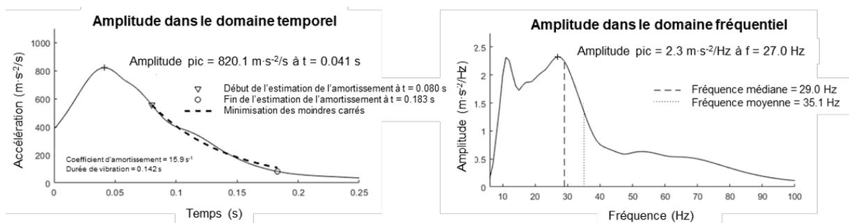
Figure 18 : Amplitude totale du signal dans le domaine temporel avec calcul de l'amortissement (gauche), et spectre fréquentiel avec calcul des fréquences d'intérêt (droite).
