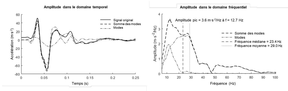
Figure 20 : Décomposition en modes intrinsèques (gauche) et transformée de Fourier rapide des différents modes (droite). Ici, le signal est composé de deux modes distincts.
