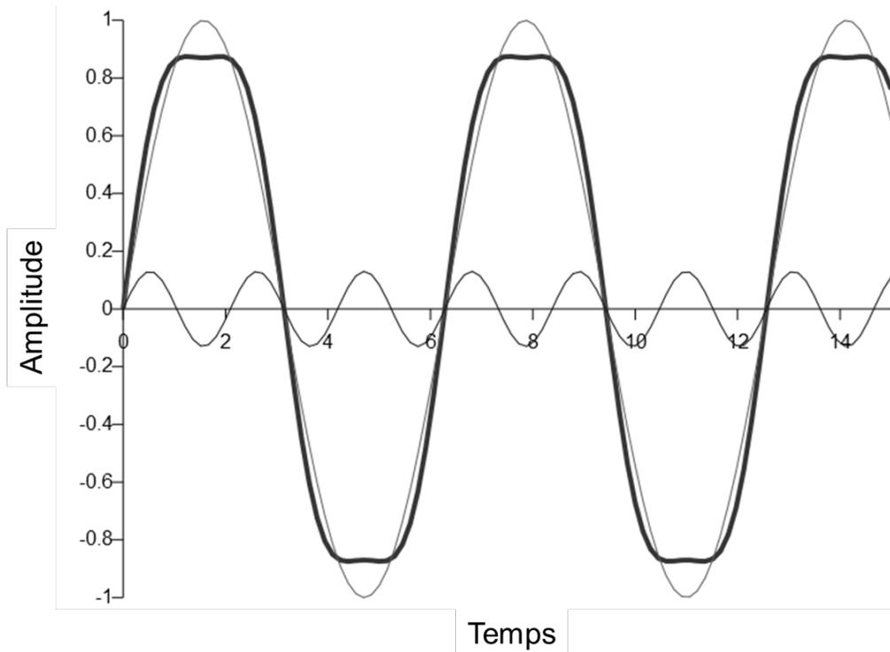
Figure 12 : Illustration de la transformée de Fourier rapide. Le signal en tracé épais est décomposé en deux sinus de fréquences différentes (tracés fins).
