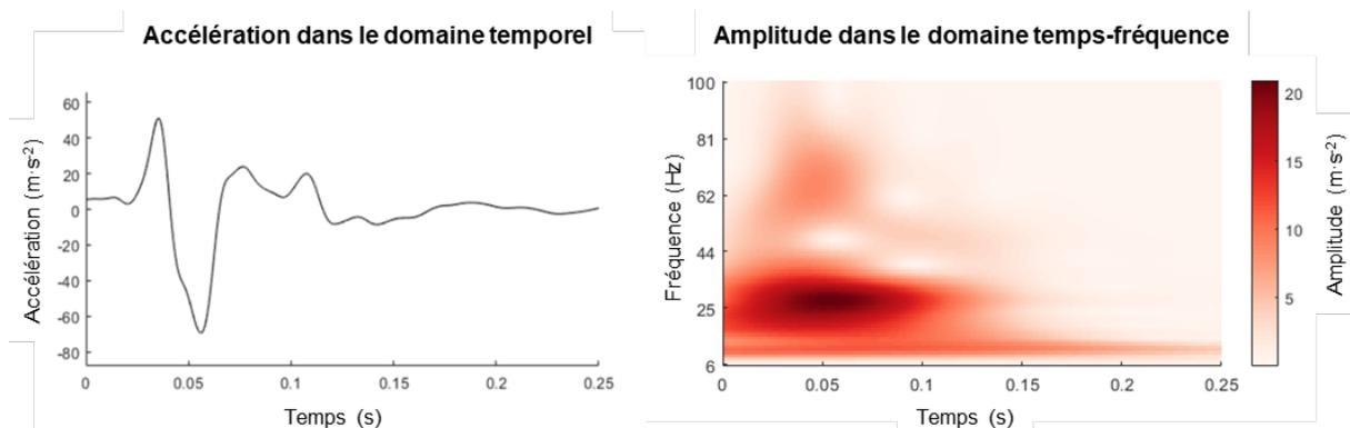
Figure 17 : Exemple d'une transformée en ondelettes continue sur un signal d'accélération. La carte à droite représente les coefficients d'ondelettes.
