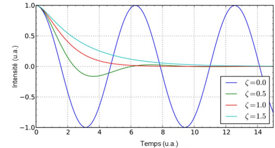
Figure 5 : Evolution de l'amplitude de la vibration au cours du temps en fonction du taux d'amortissement.
