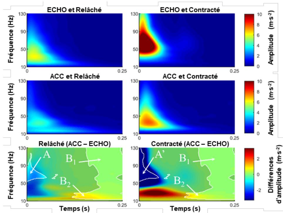
Figure 23 : Comparaison des cartes de coefficients d'ondelettes entre la mesure par accéléromètres (ACC) et échographie (ECHO). Les clusters clairs (A, B1 et B2) représentent les différences significatives entre les deux moyens de mesures obtenus avec une analyse SnPM.
