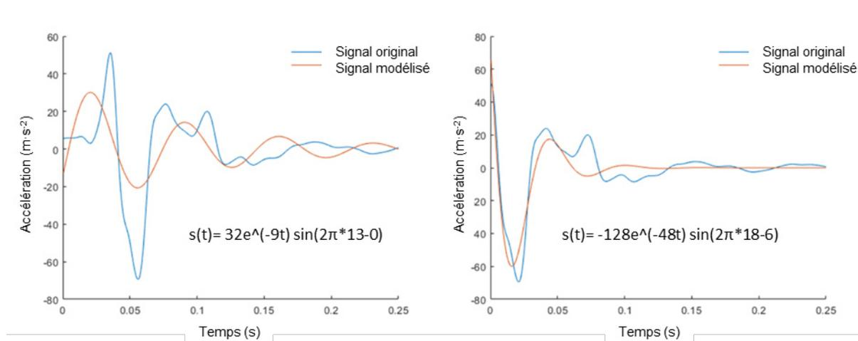
Figure 14 : Modélisation du signal temporel sous forme d'un sinus amorti en découplant le signal au niveau de l'impact au sol (gauche) ou au niveau du premier pic (droite). Dans le second cas, le signal à une amplitude de  $-128 \text{ m}\cdot\text{s}^{-2}$ , une fréquence de  $18 \text{ Hz}$ , et un coefficient d'amortissement de  $-48 \text{ s}^{-1}$ .
