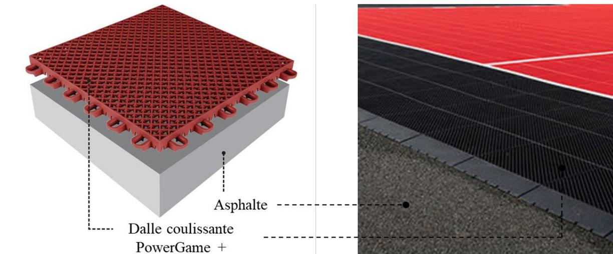
Figure 32 : Dalles coulissantes PowerGame + (Gerflor, France) installées sur de l'asphalte (en noir). Les plaques (19\*305\*305 mm) coulissent entre elles sur une distance d'environ 1 cm lors d'un impact.
