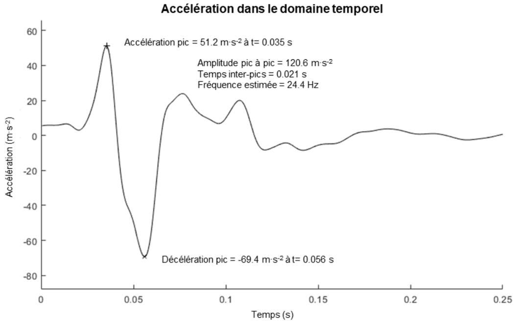
Figure 11 : Analyse temporelle d'un signal de vibration.
