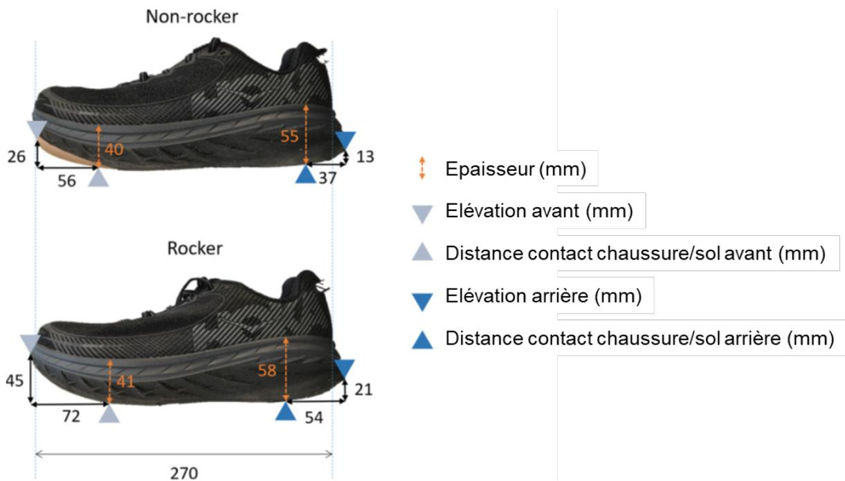
Figure 31 : Chaussure avec un faible rock comparé à une chaussure avec un rock prononcé. Les principales différences se situent sur la surface de contact au sol et les élévations avant et arrière. Adapté de Trama et al. (2019a).
