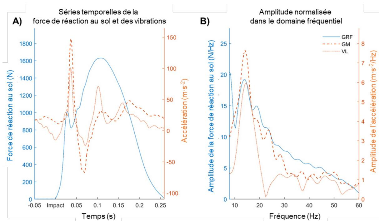
Figure 6 : A) Force de réaction au sol (GRF, bleu) et vibrations des tissus mous (orange) du gastrocnemius medialis (GM) et vastus lateralis (VL) dans le domaine temporel. Représentation des mêmes signaux dans le domaine fréquentiel. La synchronisation des pics montre le phénomène de résonance. Adapté de Trama, Play et al. (soumis).
