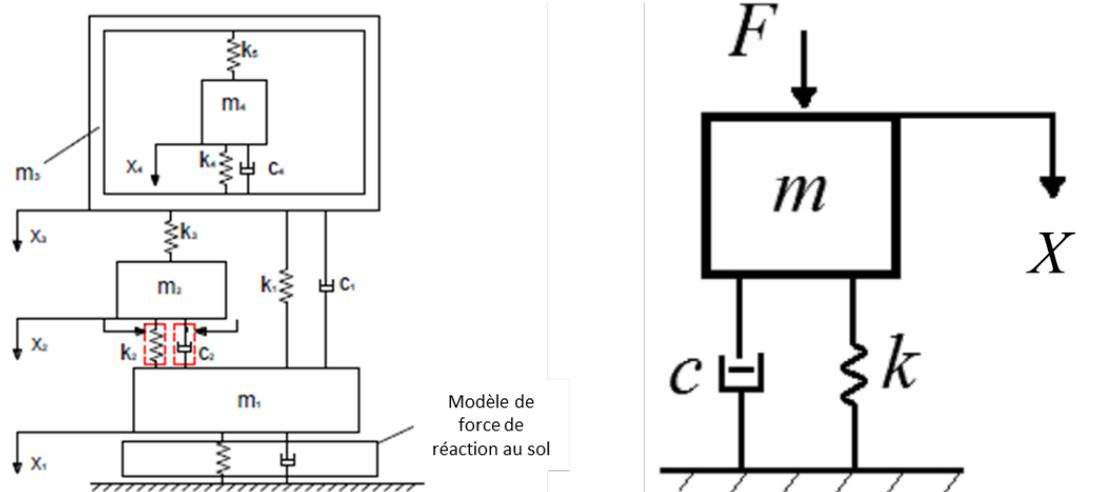
Figure 1 : Modèle masses-ressorts-amortisseurs (gauche) adapté de Nikooyan et Zadpoor (2012) et modèle masse-ressort-amortisseur simplifié (droite) adapté de Khassestarash et al. (2015b).  $m$  représente la masse du système,  $k$  sa raideur et  $c$  son coefficient d'amortissement.  $X$  est le déplacement de la masse engendré par la force de réaction au sol (modèle de gauche) ou par la force appliquée sur la masse (modèle de droite).
