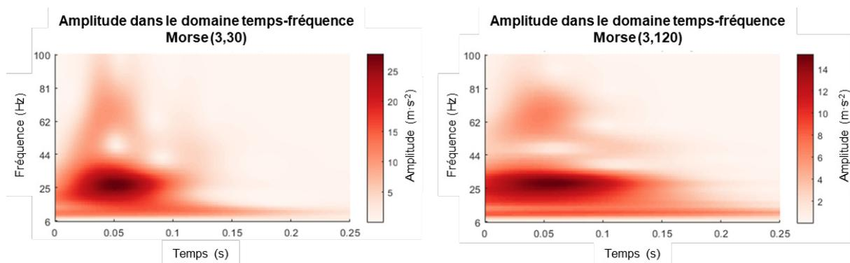
Figure 19 : Transformée en ondelettes continue du même signal avec la même famille d'ondelette (Morse), avec une meilleure localisation temporelle (gauche) ou fréquentielle (droite).
