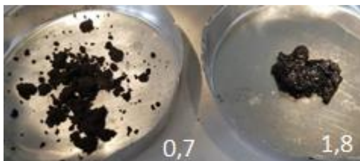
Figure 78 : Biocrudes secs issus de la liquéfaction des drêches de brasserie en batch (gauche) et en continu (droite) avec leur ratio massique biohuile/biochar respectif
