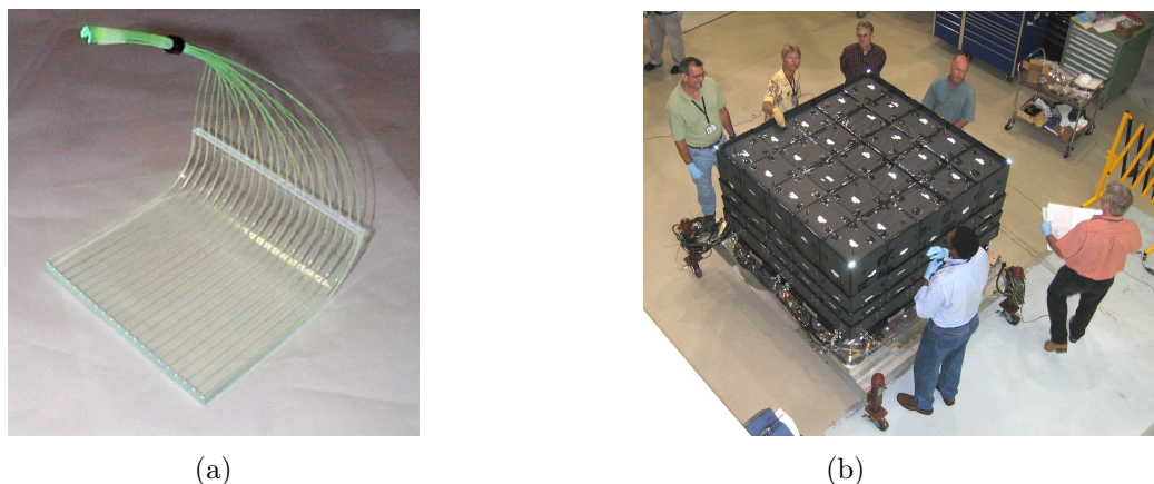
FIGURE III.5 – (a) : Tuile courbe appartenant à l'ACD. (b) : L'ACD complet entourant le LAT.
