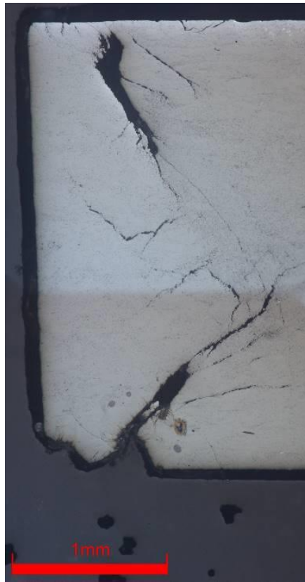
Figure V-43. Montage d'images optiques sur une tranche transversale de la pastille B2 [ T = 1320^{\circ}\text{C} – p\text{O}_2 = 2,2 \cdot 10^{-13} \text{ atm.} – v = 11 \mu\text{m} \cdot \text{min}^{-1} ].
