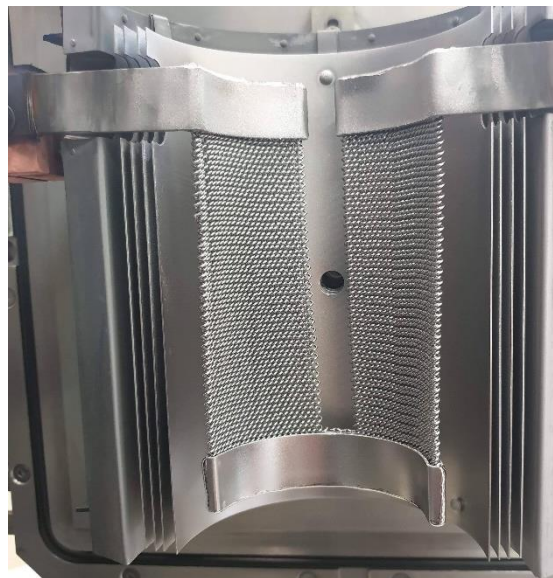
Figure III-2. Eléments chauffants : demi-coque et maillage en Tungstène
