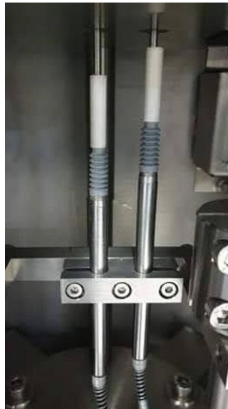
Figure III-4. Capteurs de déplacement (type LVDT), déportés en zone froide.
