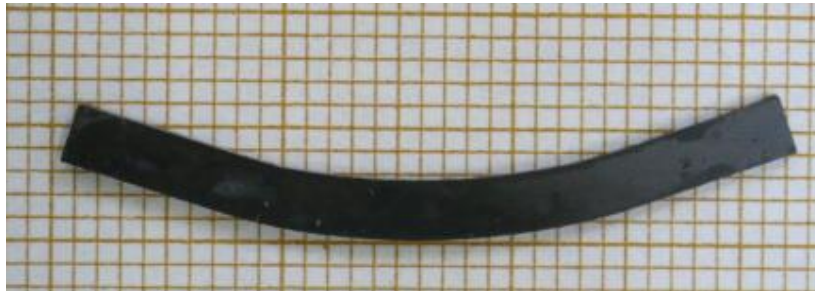
Figure VI-31. Photographie d'une éprouvette déformée en flexion 4-points jusqu'à une déformation maximale élastique de 3,3%. Echantillon C14 [ T = 1500^{\circ}\text{C} ; v = 30 \mu\text{m}\cdot\text{min}^{-1} ; p\text{O}_2 = 1,2 \cdot 10^{-10} \text{ atm} ].
