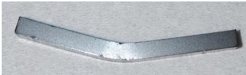
Figure VI-16. Photographie d'une éprouvette déformée en flexion 3-points. Eprouvette C11 – T = 1500°C ; p_{O_2} = 2,9 \cdot 10^{-10} atm. ; v = 60 \text{ } \mu\text{m} \cdot \text{min}^{-1} ; déformation viscoplastique maximale ~ 20%.
