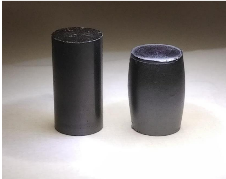
Figure V-23. Photographie de pastilles du lot A avant essai (à gauche) et après un essai de compression (à droite).
