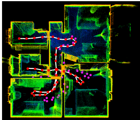
Figure 5 – Vue du dessus de la construction de carte 3D de la séquence Apartment en utilisant NAP-ICP. Les points de la carte sont colorés selon leur hauteur (le bleu correspond à la valeur la plus faible et le jaune la plus forte). Afin de rendre la lecture de la figure plus aisée, seule la construction de carte générée par l’algorithme NAP-ICP (complet). Dans cette même intention, le plafond a été retiré du nuage de point affiché ici. En blanc : la trajectoire réalité terrain. - En violet : la trajectoire calculée avec le recalage plan-à-plan uniquement . - En rouge : la trajectoire calculée avec l’algorithme complet de NAP-ICP (recalage plan-à-plan suivi du point-à-plan.)
