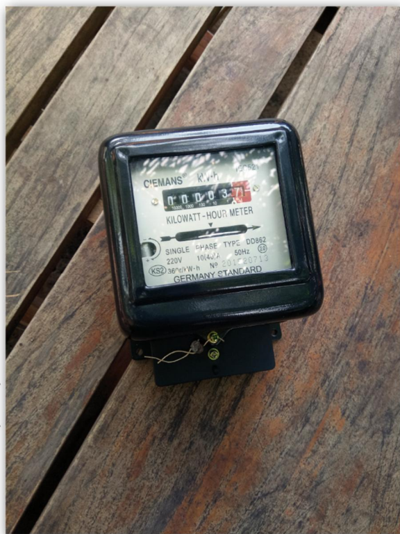
PHOTO 40 : DÉCOMPTEUR NON CERTIFIÉ À AFFICHAGE MÉCANIQUE
