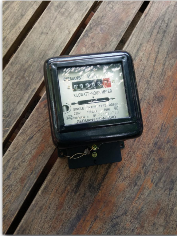
PHOTO 40 : DÉCOMPTEUR NON CERTIFIÉ À AFFICHAGE MÉCANIQUE
