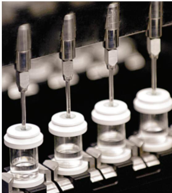
Figure 1 : Flacons clos Crystal<sup>®</sup> et système de remplissage automatisé
