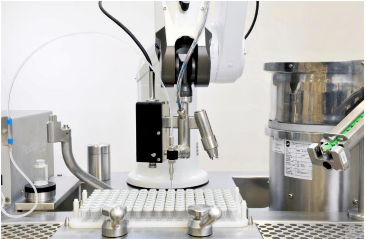
Figure 25 : Ligne automatisée de remplissage L1 Robot Line
