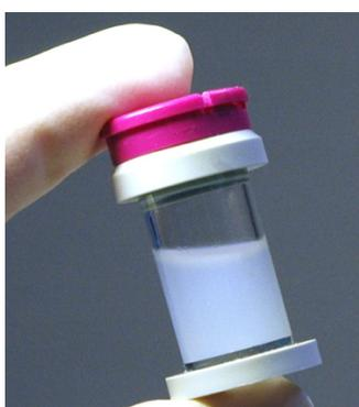
Figure 24 : Flacon Crystal® rempli après mise en place du « flip-off »
