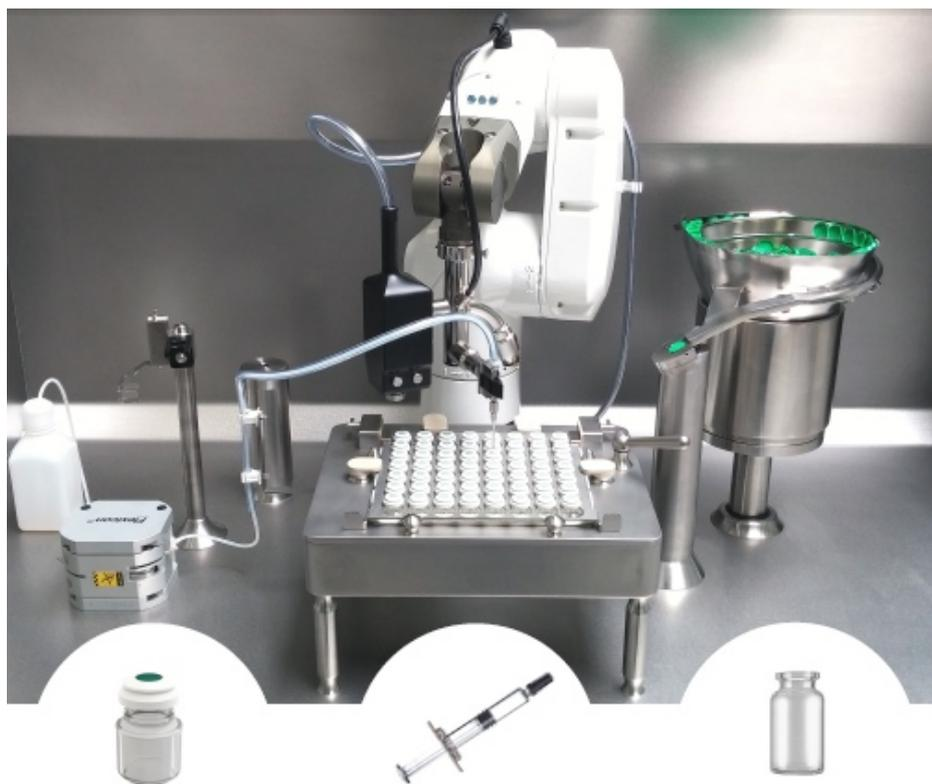
Figure 27 : Ligne polyvalente de remplissage SL1 Robot Line
