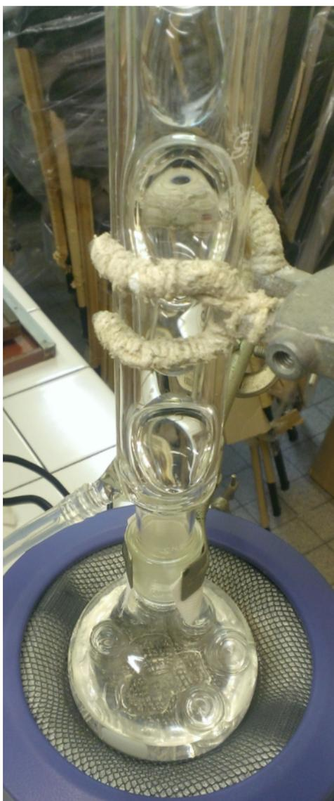
Figure 54 : Montage à reflux utilisé pour l'extraction des différents matériaux du flacon Crystal® (ici le corps en COC)
