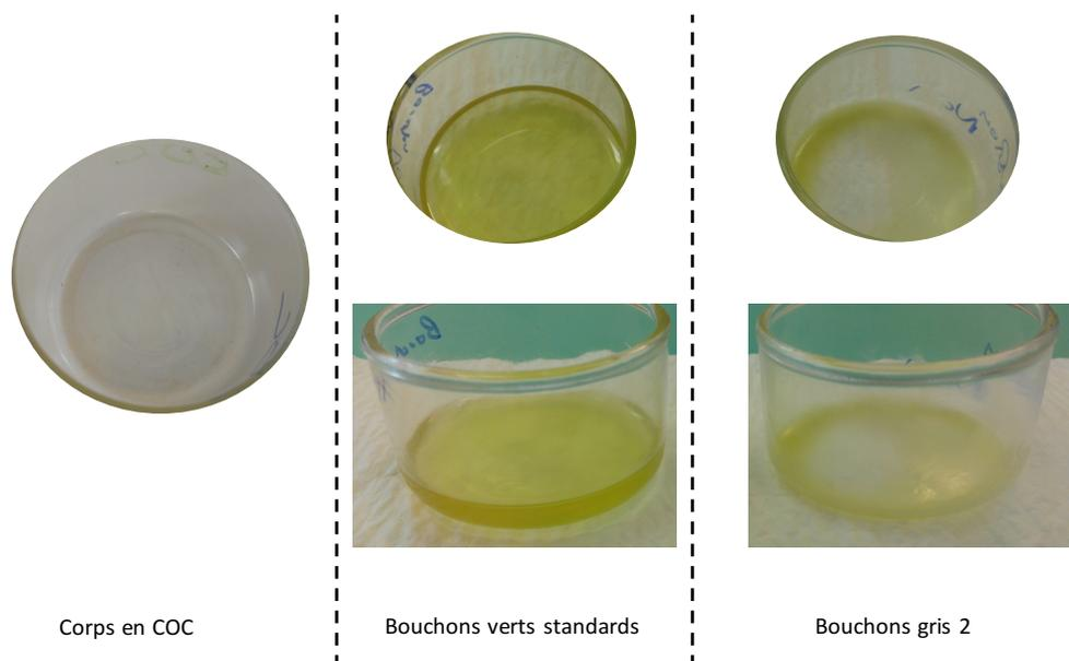
Figure 55 : Résidus présents dans les cristallisoirs après la phase d'extraction dans l'isopropanol
