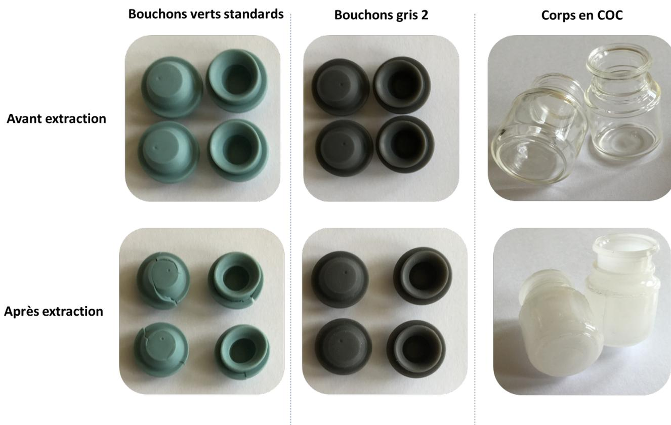
Figure 56 : Observations macroscopiques des flacons et des bouchons avant et après le processus d'extraction
