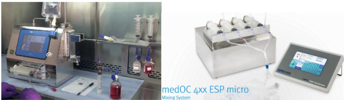
Figure 21 : Systèmes de remplissage à piston ICU Diana™ et Medoc 4 voies
