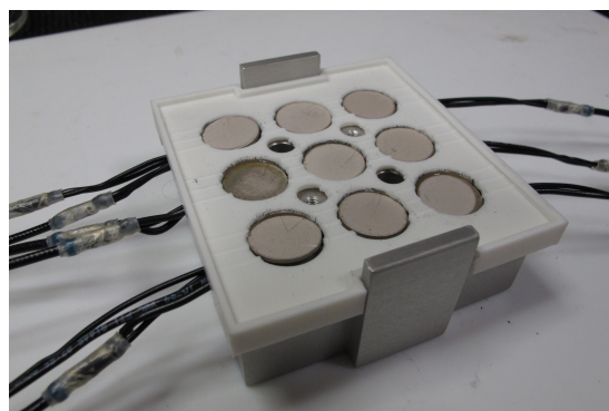
(b) Mise en place des capteurs avec la pièce de mise en position latérale.
