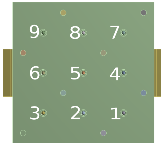
FIGURE 2.8 – Vue de dessus de la modélisation du patin indiquant les numéros par lesquels sont désignés les capteurs et leur aspérité correspondante tout au long de ce manuscrit.
