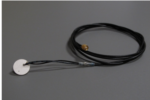
FIGURE 2.16 – Photographie d'une céramique piézoélectrique après soudure des fils sur les électrodes.
