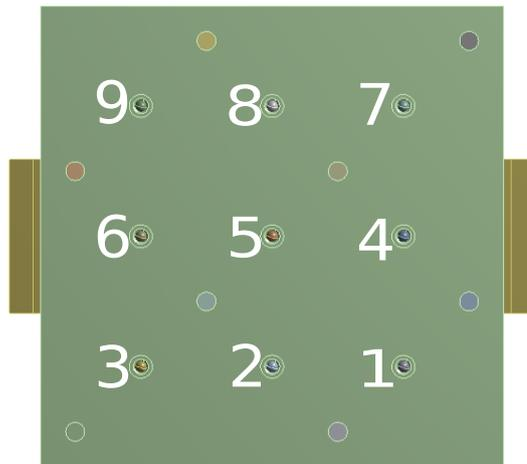
FIGURE 2.8 – Vue de dessus de la modélisation du patin indiquant les numéros par lesquels sont désignés les capteurs et leur aspérité correspondante tout au long de ce manuscrit.
