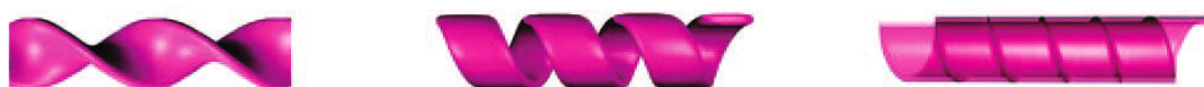
FIGURE 1.9 – Modélisation des trois types de structures chirales obtenues par l'auto-assemblage en solution en présence de contre-ions chiraux. De gauche à droite : ruban twisté, hélice et tubule (adapté de [57]).
