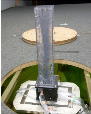
(a) Maquette de la tour avec prises de pression.
