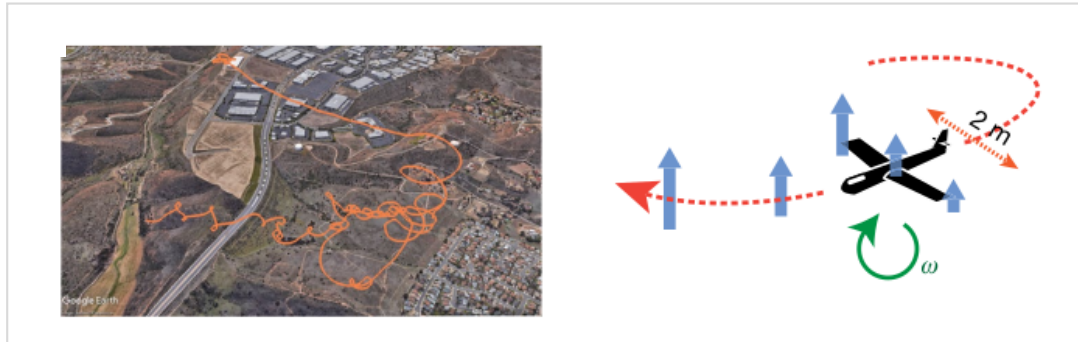
(a) Une maquette de planeur (2 mètres d'envergure) évolue au dessus d'un champ. La figure de gauche illustre l'une des trajectoires. La maquette a accès aux gradients de vitesse verticale (flèches bleues), l'accélération verticale et le moment de roulis. Les expériences sont réalisées avec un contrôleur de vol initial permettant de moduler l'inclinaison et l'assiette pour maximiser la portance.
