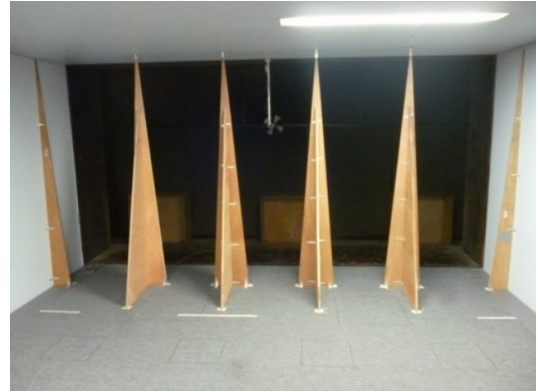
(b) Générateurs de vortex en entrée de veine.
