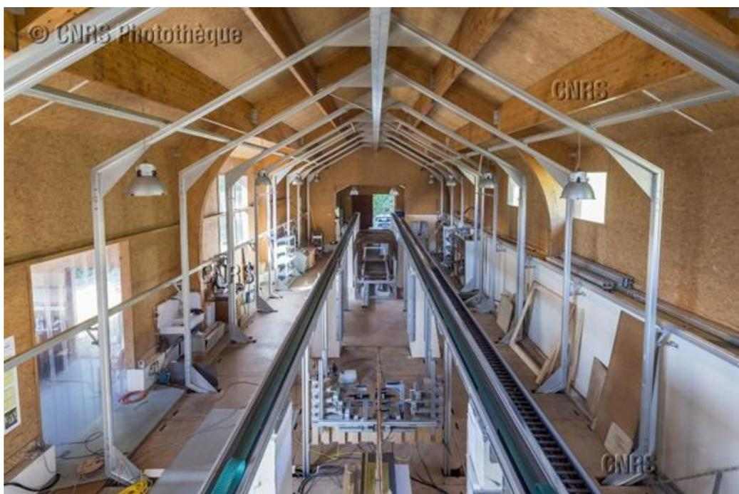
Figure IV. 1 : Vue du simulateur de champ magnétique faible utilisé pour l'étude expérimentale.
