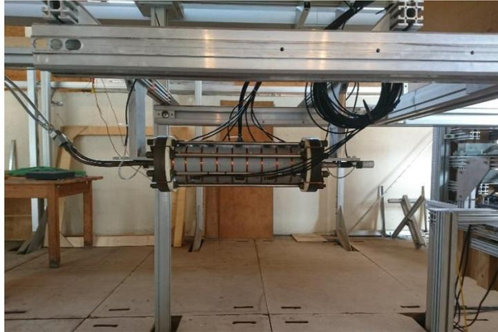
**Figure IV. 8 : Cylindre se déplaçant sur le charriot mobile**
