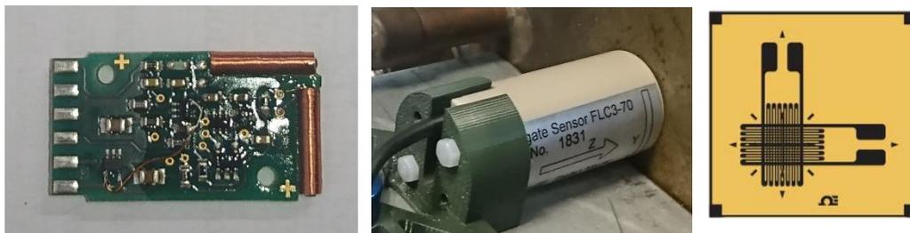
**Figure IV. 3 : De gauche à droite, capteur biaxe, capteur tri-axe, jauge de contraintes**
