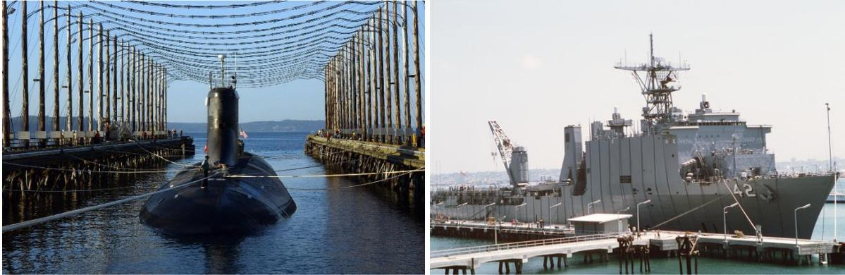
**Figure I.9 : Dispositifs de traitement magnétique fixe (à gauche) et amovible (à droite), (Source Wikipédia)**
