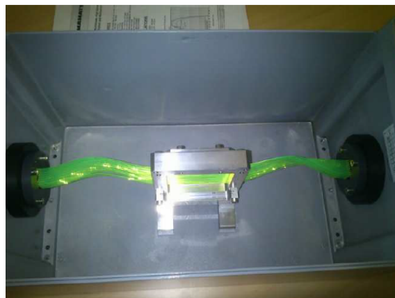
FIGURE 2.12 – Prototype du réseau de fibres optiques.
