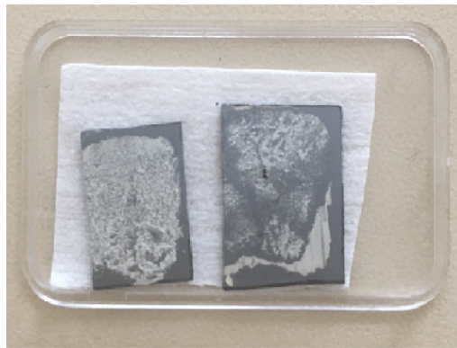
FIGURE 4.6 – Face arrière des échantillons ZnSAg001 (gauche) et ZnSAg004 (droite). La distribution de la laque d'argent n'est pas suffisamment homogène sur l'échantillon ZnSAg004.
