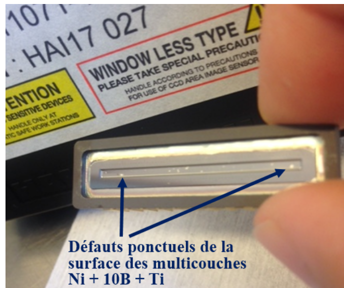
FIGURE 4.25 – Le CCD 027 après le dépôt B0011. Quelques défauts ponctuels de couleur blanche sont visibles.
