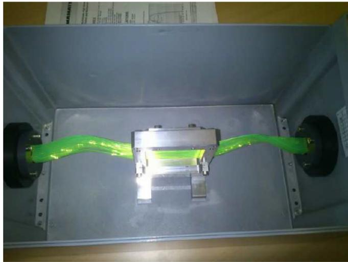
FIGURE 6.1 – Prototypé du réseau de fibres optiques dans la boîte étanche à la lumière.
