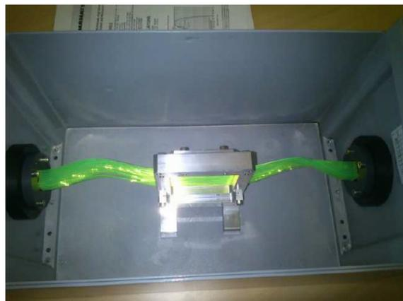
FIGURE 2.12 – Prototype du réseau de fibres optiques.
