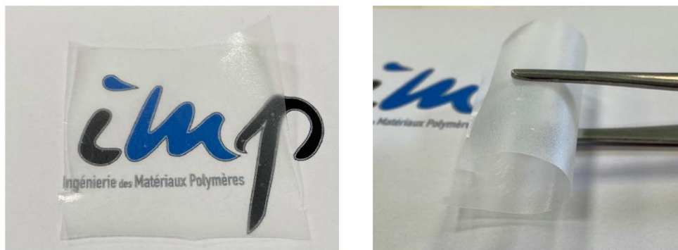
Figure III.1 : Photographies montrant la transparence et la souplesse d'un film Pebax ® référence.
