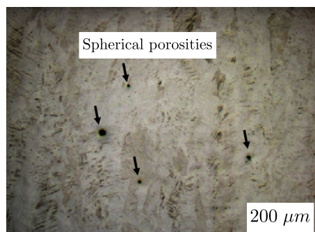
FIGURE 6 – Photo de porosités sphériques présentes dans une pièce formée par SLM [5].
