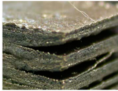
FIGURE 9 – Photo du phénomène de délaminage pour une pièce.
