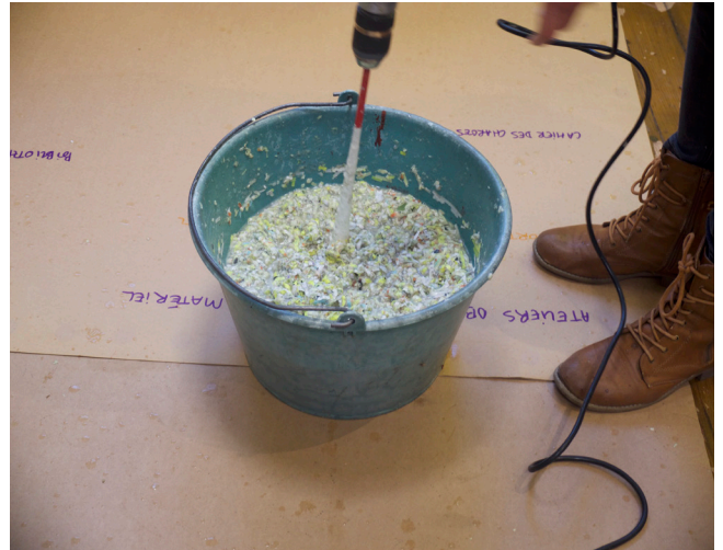
fig.801 : Broyage du papier avec une perceuse et le mélangeur
