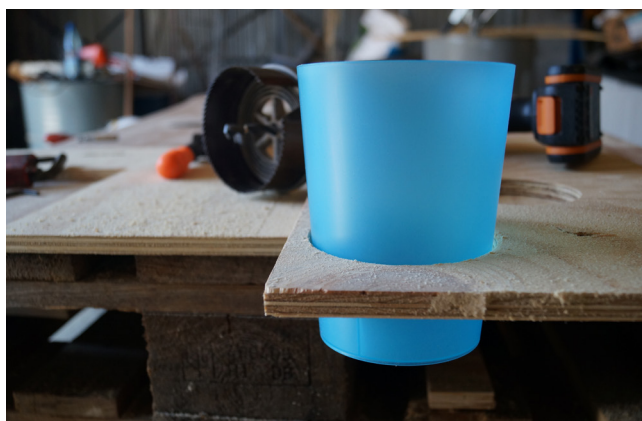
fig.605 : La création des cavités des tiroirs pour les gros gobelets
