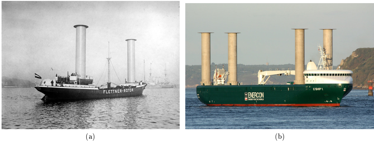
FIGURE I.26 – A gauche : le premier navire équipé de rotor Flettner, le "Buckau" ; A droite : le navire E-Ship 1 de la société Enercon (crédit photo : Michel Floch, septembre 2011).
