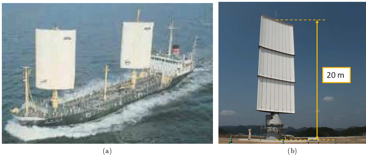
FIGURE I.18 – A gauche : le système à voile rigide "Jamada" sur le navire "Shin-Aitoku-Maru" (38) ; A droite : Le système à voiles rigides du projet Wind Challenger lors d'essais à terre.
