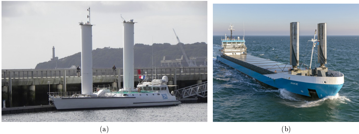
FIGURE I.30 – A gauche : "l'Alcyone" (1985) de la Fondation Cousteau (85) ; A droite : le "Ankie" équipé en 2019 de deux "ventifoil" de Econowind (89).
