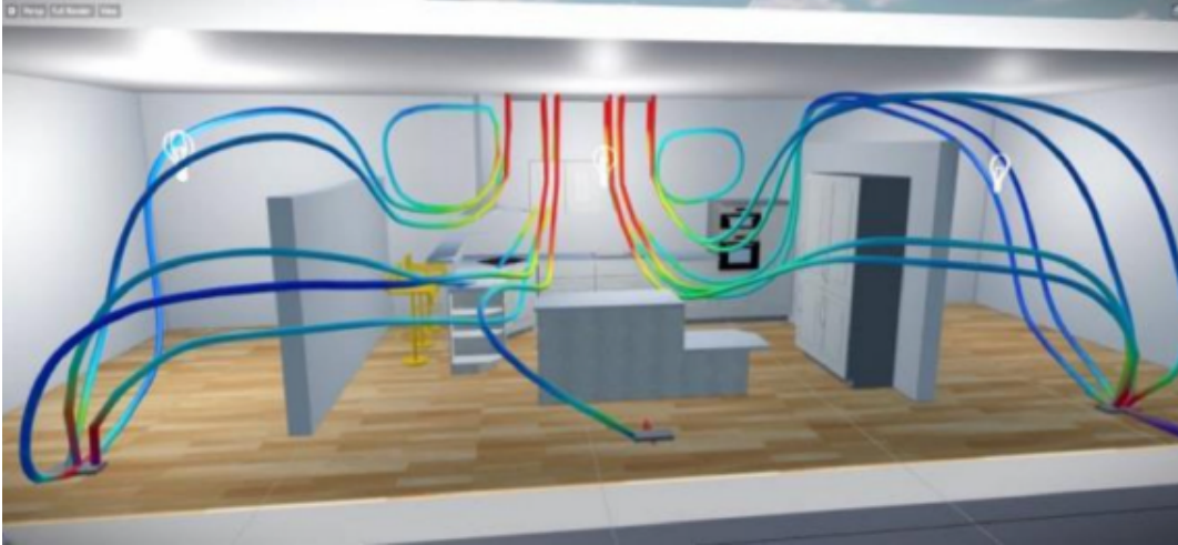
FIGURE 3.6 – Visualisation CFD dans une scène de RV (YAN et al., 2020).
