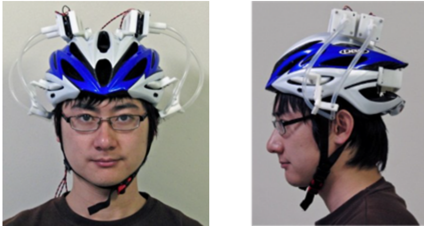
FIGURE 3.14 – Casque adapté avec des hautparleurs et ventilateurs (KOJIMA et al., 2009).
