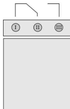
FIGURE 4.6 – Schéma conceptuel du fonctionnement du relais. (I) Contact normalement ouvert (contact lié au contact commun si le relais est désactivé), (II) contact commun (II) contact normalement fermé (contact lié au contact commun si le relais est activé).
