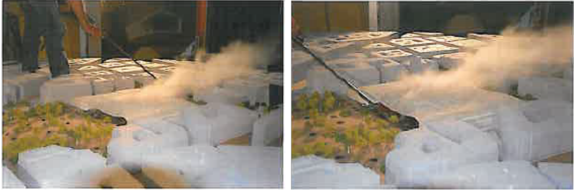
FIGURE 2.21 – Visualisations du comportement aérouliqu par injection de fumée (FAURE et FLAMAND, 2009).
