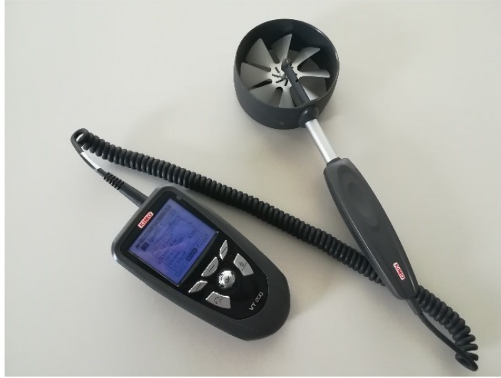
FIGURE 4.2 – Anémomètre kimo vt200 utilisé pour les mesures de la vitesse du vent des ventilateurs.
