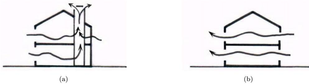
FIGURE 1.2 – (a) tirage thermique (*Stack effect*) et (b) ventilation croisée (SØRENSEN, 2009 cité par WIDERA, 2014)
