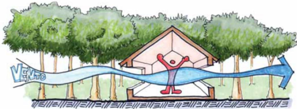
FIGURE 2.17 – Principe de la ventilation croisée (LAMBERTS et al., 2014).
