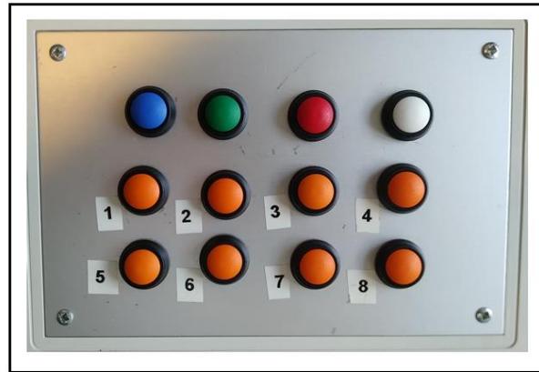
Figure 24 : Boîtier de réponse avec trois rangées de boutons. La première est composée par 4 couleurs (bleu, vert, rouge, blanc) ; la deuxième par des chiffres de 1 à 4 ; la troisième par des chiffres de 5 à 8.
