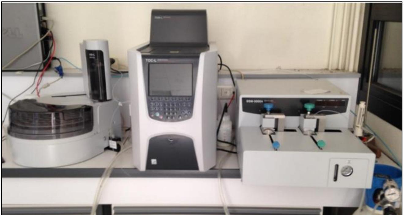
Figure 61. L'analyseur de carbone Shimadzu TOC-L CSH/CSN couplé à un module solide Shimadzu SSM-5000A (Photo : E. Weisskopf).
