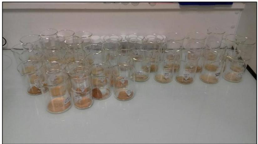
Figure 53. Une série d'échantillons tamisés à 2 mm pour les analyses granulométriques (Photo : M. Stern).
