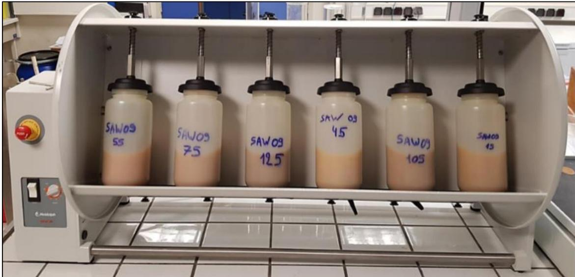
Figure 55. Agitation pendant 12 h des échantillons en solution d'hexamétaphosphate de sodium
