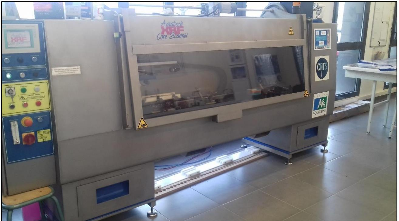
Figure 64. XRF core scanner de l'UMR CNRS 5805 EPOC, à l'Université de Bordeaux (Photo : M. Stern).
