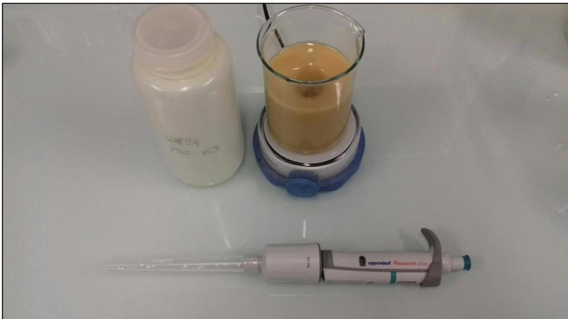
Figure 56. Agitation d'un échantillon au barreau magnétique avant la mesure de granulométrie laser
