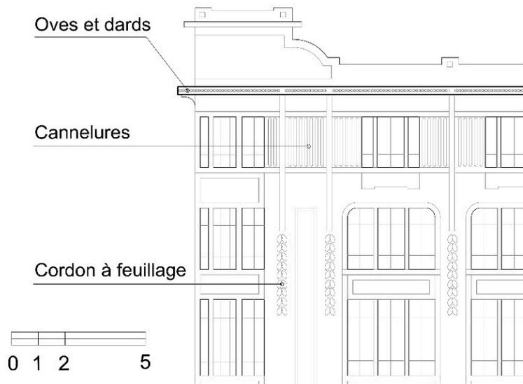
Figure 294. Détail de la façade nord du bâtiment *CIDOSA*, AMPC.
