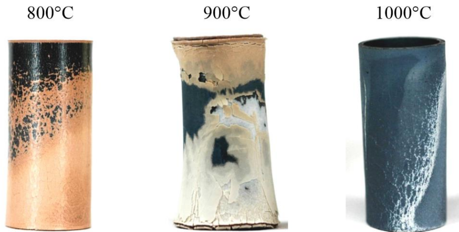
Figure 1.20 : Images macroscopiques des échantillons de gaine après oxydation sous air (Idarraga, 2011).
