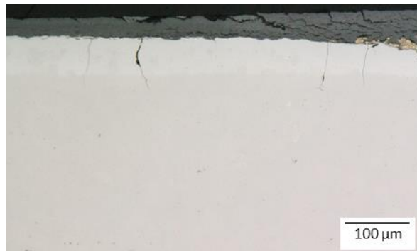
Figure J.1 : Image en microscopie optique de l'échantillon sous condition 3 (vapeur d'eau, oxygène et azote) à 950 °C pendant 2h.
