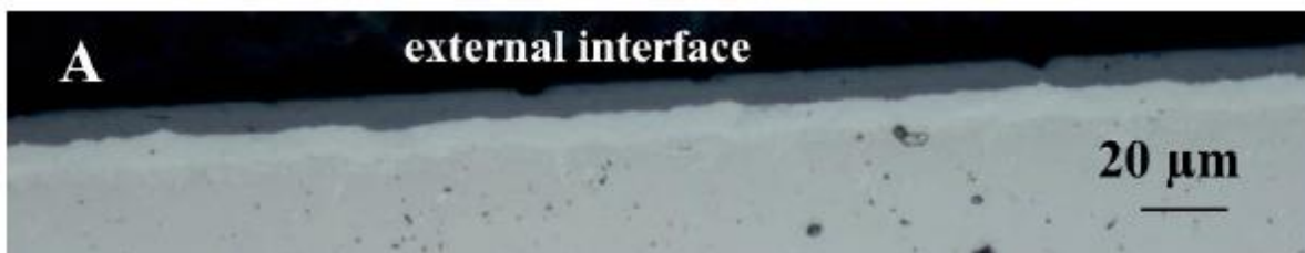
Figure 1.14 : Image optique du Zy-4 oxydé sous 20 % O_2 – 80 % N_2 à 850 °C dans le domaine pré-transitoire (Lasserre-Gagnaire, 2013).
