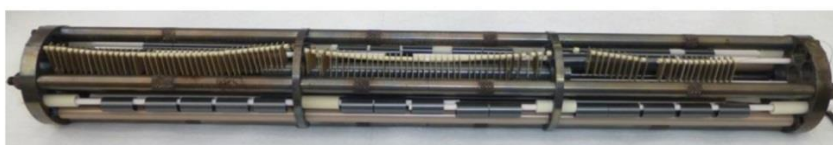
Figure 2.1 : Porte-échantillons du four de pré-oxydation.
