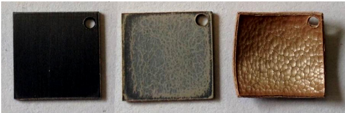
Figure C.2 : Photographie d'échantillons oxydés sous air à 850°C pendant 15 min (gauche), 30 min (centre), 4h15 (droite). Montée en température sous He et isotherme sous air.
