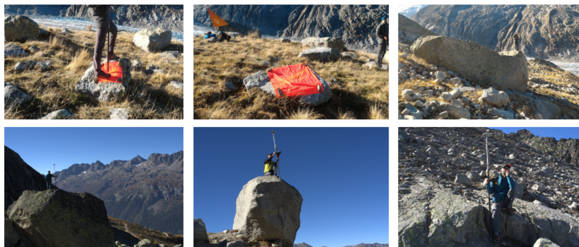
FIGURE 7.1 – Exemples d’images acquises lors d’une mission terrain pour la collecte de mesures GPS in-situ en rive droite (haut) et gauche (bas). Lors des sorties terrain et étant donné que le site étudié s’étend sur des kilomètres, les points à mesurer doivent tout d’abord être repérés conjointement sur les deux points de vue gauche et droit et sur un modèle numérique de terrain afin de naviguer efficacement. L’ensemble des données in-situ peuvent être visualisées sur le modèle numérique de terrain de la figure 5.12.
