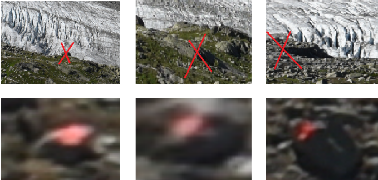
FIGURE 7.2 – Exemple de points repérés et géo-références sur une acquisition témoin. Les points marqués avec une flèche rouge désignent des objets géophysique saillants trouvés sur le site d'Argentière et les zones de couleur orange sont des bâches placées sur le site le jour de l'acquisition témoin.
