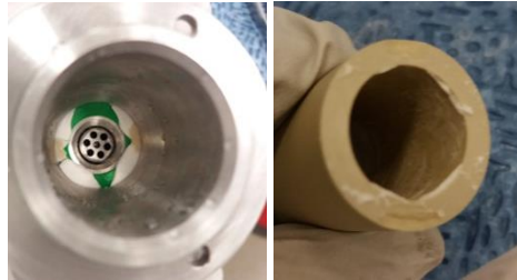
Figure 154 A) Vu de l'intérieur de la deuxième cellule conçue avec des morceaux de la membrane de TiO_2 B) Membrane en TiO_2 présentant des éclats après utilisation
