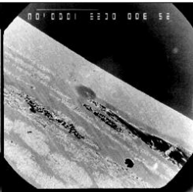
Figure 38 : Coupe transversale du matériau A après 800 h d'immersion à 60°C en eau distillée.
