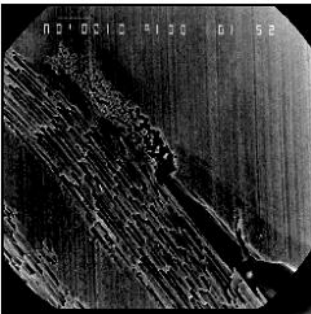
Figure 37 : Coupe transversale du matériau A après 500 h d'immersion à 60°C en eau distillée.
