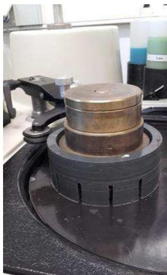
*Figure VI.1. Dispositif automatisé de rodage des disques céramiques*
