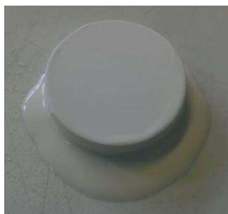
*Figure V.4. Dépôt par bar coater sur disque céramique*
