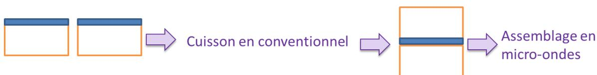
Le verre est déposé sur chaque pièce en céramique, qui est traitée thermiquement en four conventionnel, puis deux pièces ainsi émaillées sont assemblées par chauffage micro-ondes. Nous verrons que cette nouvelle technique a permis d'atteindre une meilleure qualité d'assemblage.
