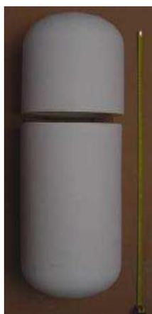
Figure II.1. Prototype d'un conteneur en céramique [AND2013]
