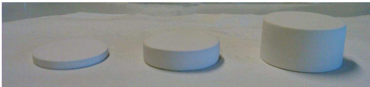
Figure IV.5. Disques en céramique alumino-silicatée de diamètre 40 mm et d'épaisseur 5, 10 et 25 mm respectivement (de gauche à droite)
