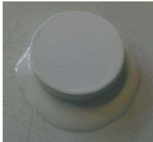
*Figure IX.5. Exemple de dépôt par bar coater sur la céramique Andra*
