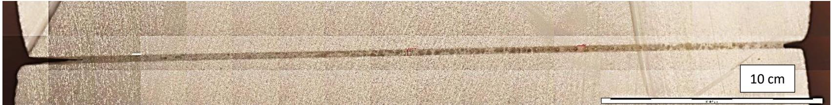
*Figure IX.20. Observation en microscopie optique de l'interface de l'assemblage réalisé avec le verre A19C*
