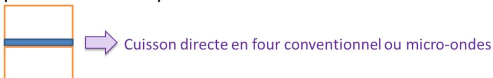
Le verre est déposé sous forme de barbotine sur une pièce en céramique, puis une autre pièce est mise en place par-dessus et l'assemblage subit un traitement thermique par micro-ondes. Cette voie a été utilisée pour la phase de faisabilité (projet Scellmo et année 1 du projet Noumeha, ainsi qu'au début de cette thèse).
