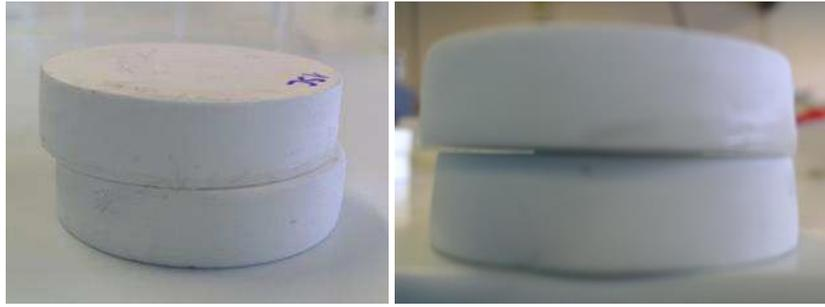
Figure IX.3. Assemblage obtenu après traitement thermique (REL63)
