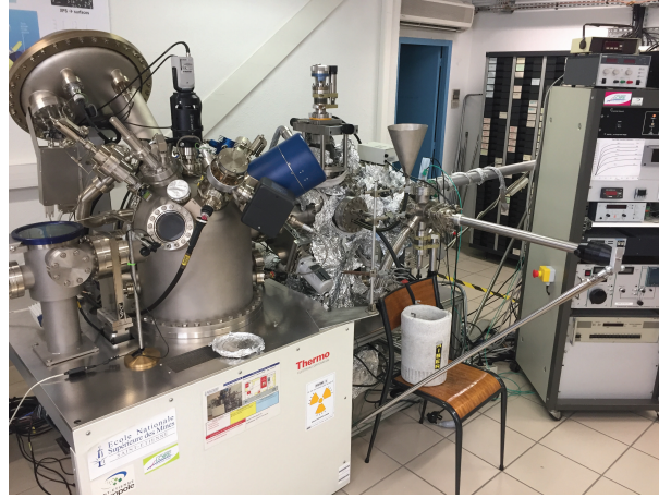
FIGURE 2.19 – Instrument de mesure Thermo VG Thetatrop du département MPI (Mécanique Physique et Interfaces) utilisé pour les caractérisations par spectroscopie Auger et spectroscopie XPS
