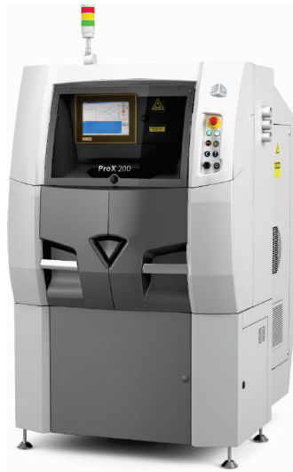
FIGURE 2.22 – Machine d'impression 3D SLM ProX200 de la société 3D-Systems
