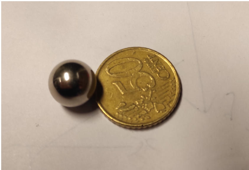
FIGURE 5.20 – Photographie de la bille utilisée pour l'excitation par roulement.
