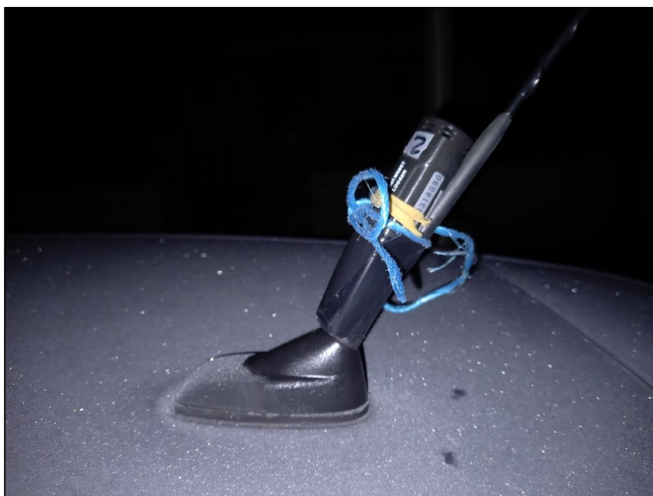
Figure 188 : Data logger accroché sur l'antenne de l'automobile
