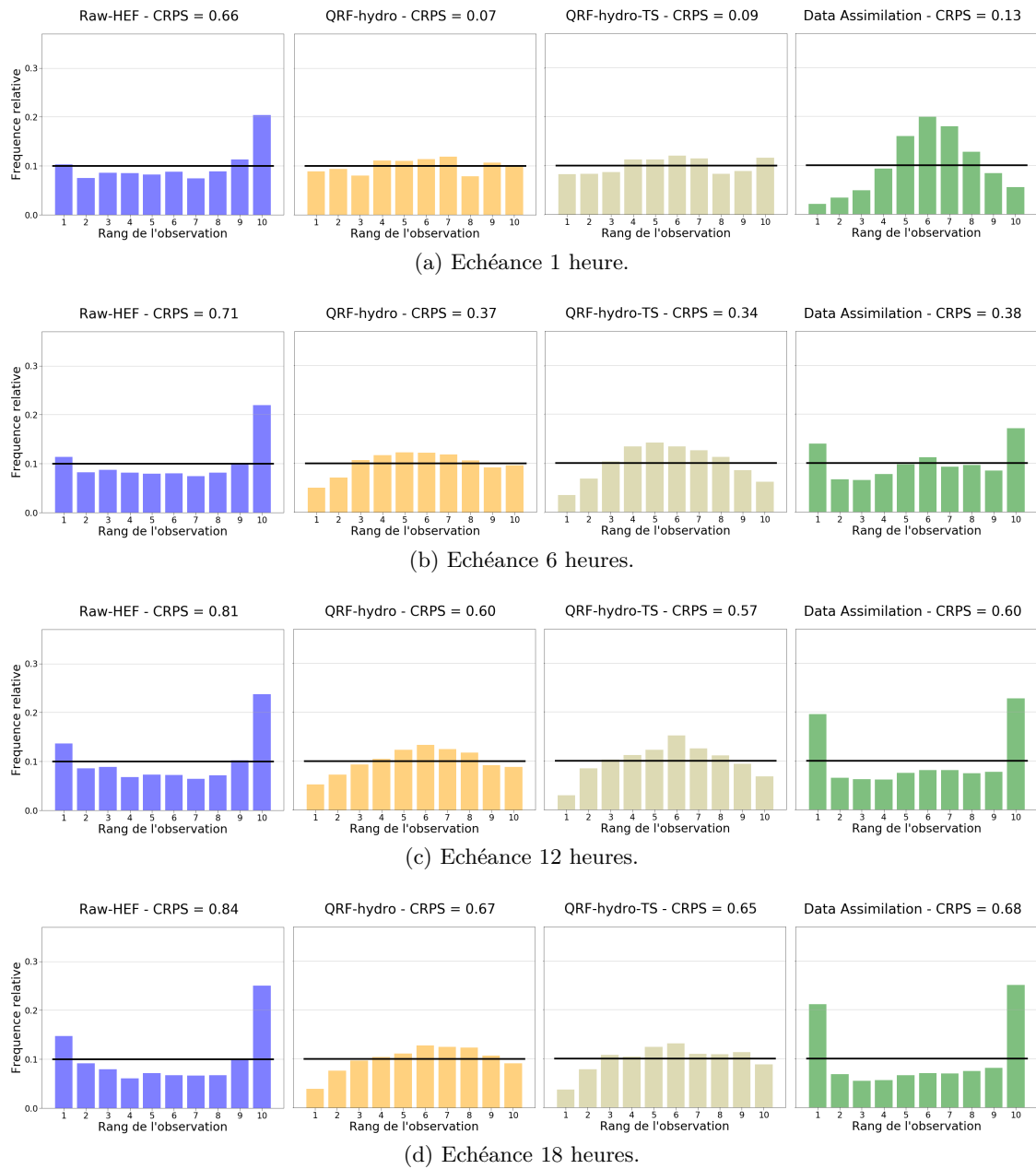
Figure P.9: Histogrammes de rang des prévisions pour les ensembles raw , QRF-hydro , QRF-hydro-TS et Data assimilation , pour les échéances 1 heure, 6 heures, 12 heures et 18 heures à Kerjean.
