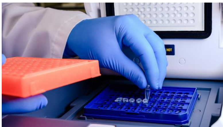
Figure 66. Image d'un thermocycleur ouvert. Les échantillons dans les tubes à PCR sont chauffés au niveau du couvercle lorsque la partie supérieure (blanche sur l'image) se referme sur les tubes.
