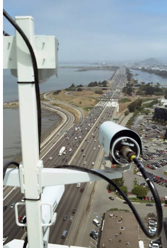
Figure 4: Exemple de caméra fixe sur autoroute. 11
