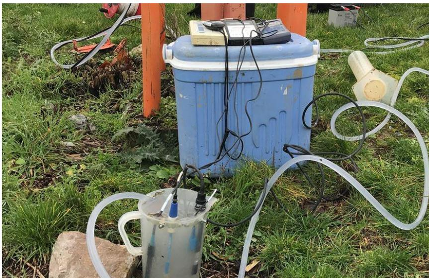
Figure 5 : Illustration du suivi des paramètres physico-chimiques pendant la purge à l'aide de sondes multi-paramètres.
