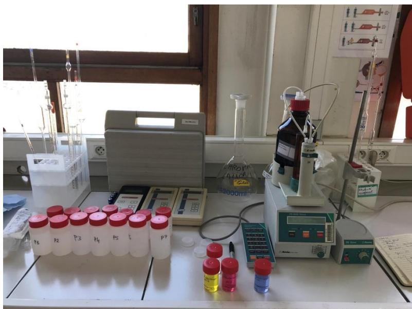
Figure 6 : Titrimètre automatique utilisé pour la titration de l'alcalinité des échantillons
