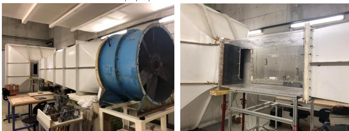
Figure 255 Soufflerie physique à l'ENPC 171
