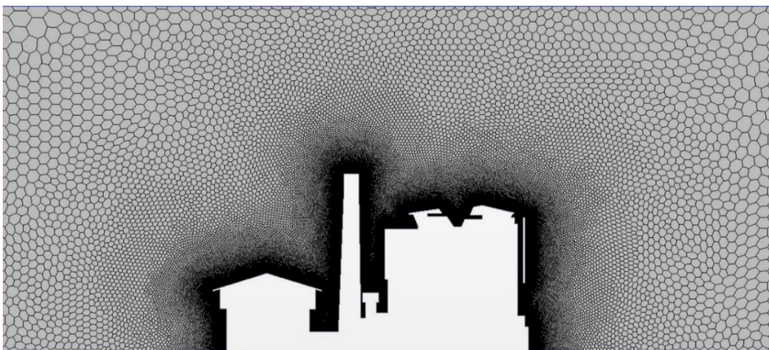
Figure 210. Définition du maillage d'analyse aéroulique sur le modèle 3D de l'ENSAPVS, selon une coupe verticale Est-Ouest
