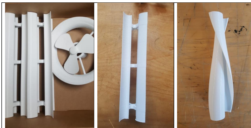
Figure 246 Impression 3d des éoliennes pour la réalisation de maquettes d'étude d'intégration du dispositif ; Etape intermédiaire
