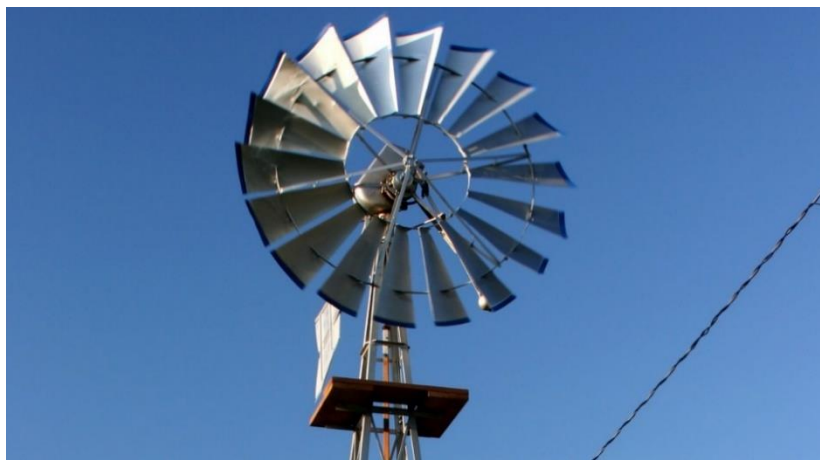
Figure 289. Eolienne de pompage
