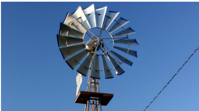
Figure 289. Eolienne de pompage
