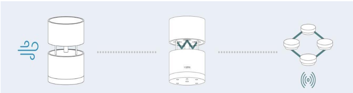
Figure 83. Schéma de fonctionnement de l'anémomètre à Ultrasons connecté par Netatmo site
