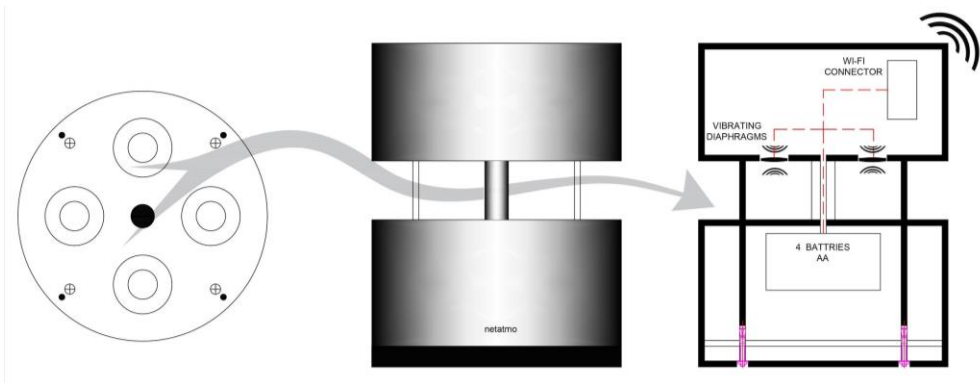
Figure 85. Plan, élévation, coupe de l'anémomètre utilisé
