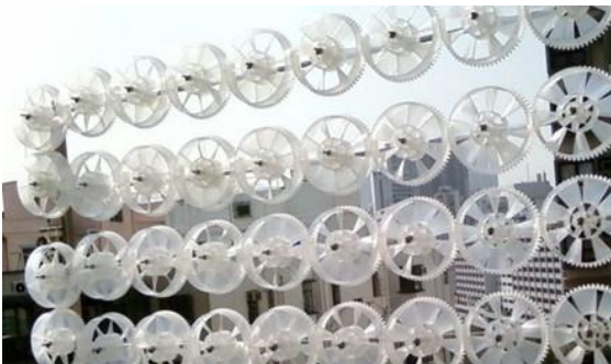
Figure 230 Mode de mise en « cluster » de dispositifs éoliens (fonctionnement en groupes de turbines rapprochées)
