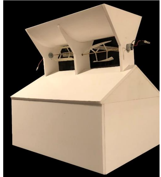
Figure 249. Maquette d'étude initiale avec 2 turbines. Leur géométrie n'est pas adaptée au foil avec un régime moins important sur la turbine en hélice.
