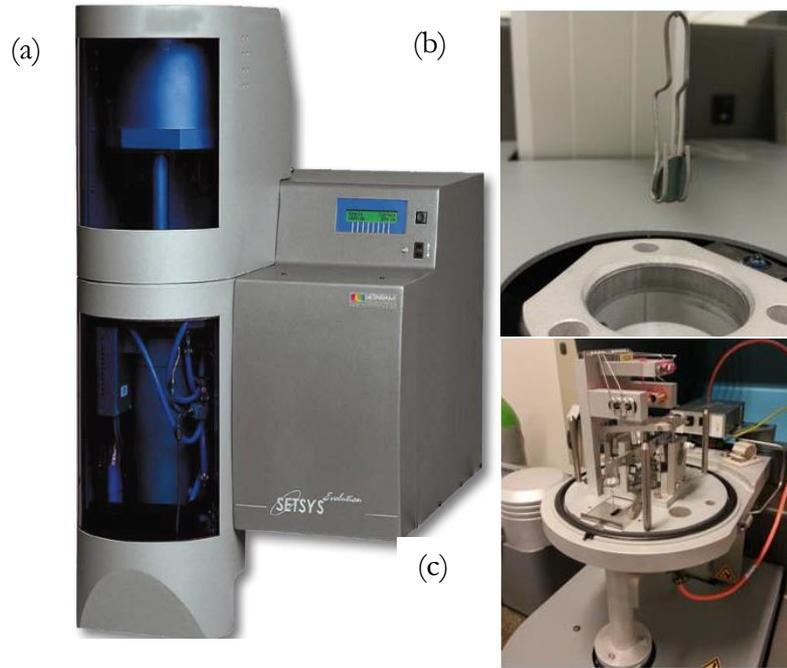
Figure II.6 : (a) Photographie de l'appareil ATG Setsys Evolution de chez SETARAM, (b) Photographie du montage de l'échantillon de  $Ti_2AlC$  sur la griffe Pt-Rh10%, (c) Photographie de la microbalance.
