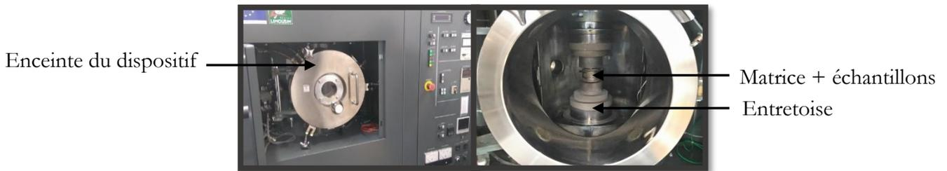
Figure II.4 : Dispositif de frittage flash Dr Sinter(r) modèle SPS-825.
