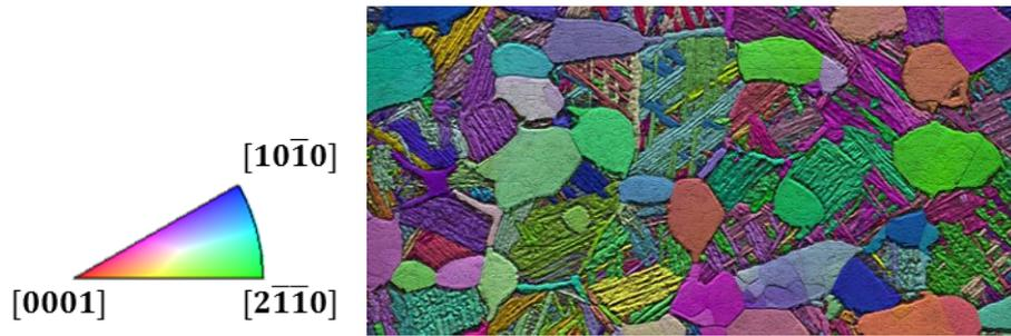
Figure II.20 : Exemple de cartographie obtenue par analyse EBSD : Microstructure bimodale de  $Ti_6Al_4V$  - Cartographie EBSD selon la normale à la surface et couplé avec l'indice de Qualité des diagrammes de diffraction
