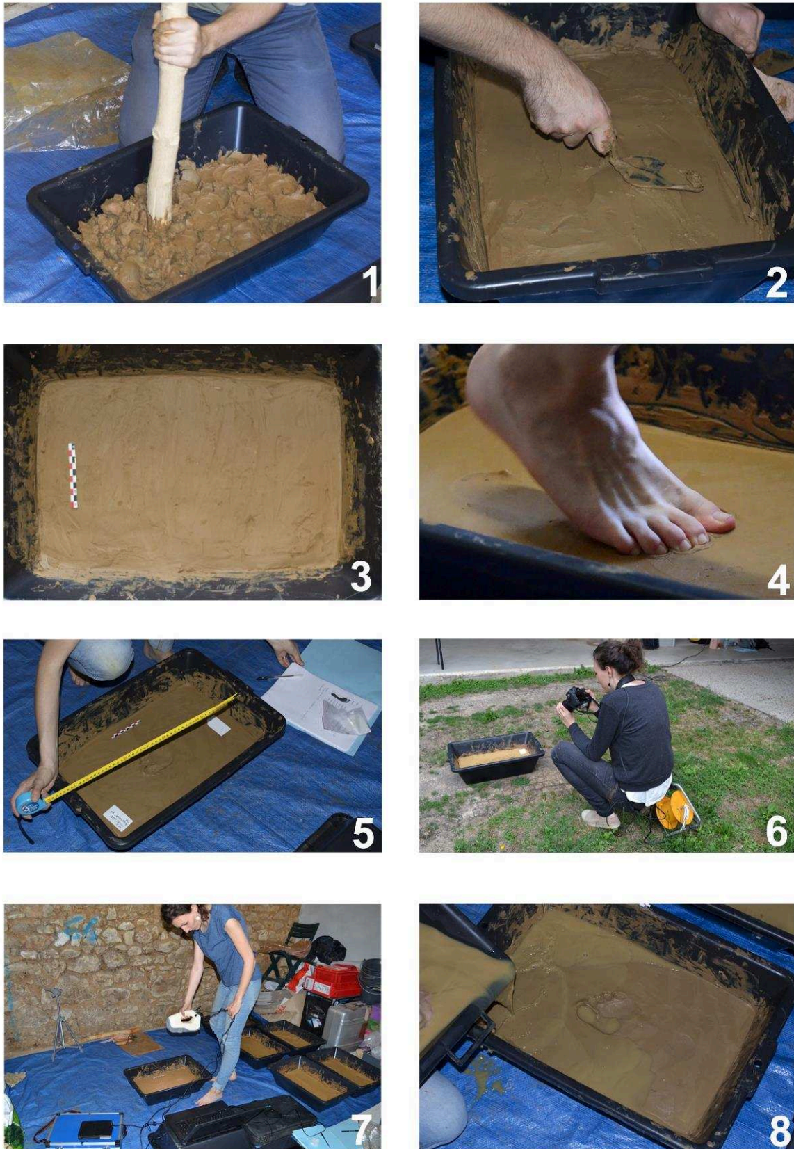
Figure 55 : Déroulement des expérimentations. 1, 2 et 3 : préparation de la surface, 4 : réalisation de l'empreinte, 5 : mesure et description de l'empreinte, 6 et 7 : enregistrement (photographie et scanner surfacique), 8 : ennoiemt.
